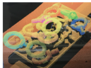
部品検査 マッチングによる部品形状検査
